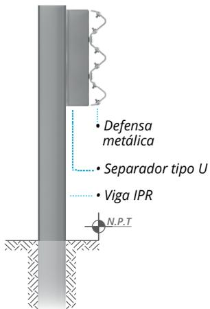
✓ Fabricación conforme a la norma AASHTO M180
